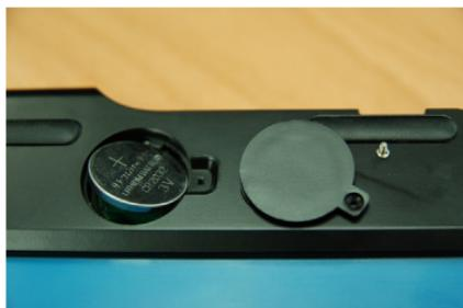
2. Inserire la nuova batteria, e poi coprire il coperchio e serrare la vite per terminare.
