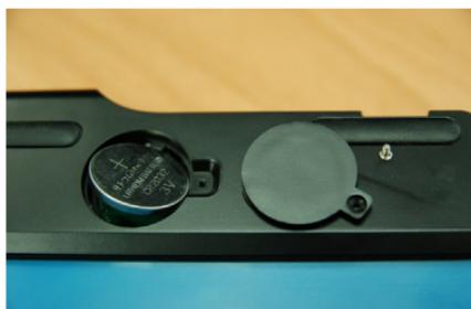
2. Mettez la nouvelle pile, puis replacez le couvercle de la batterie et serrez la vis pour finir.
