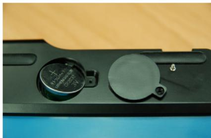
2. Legen Sie die neue Batterie ein. Daraufhin schließen Sie die Batterieabdeckung und ziehen die schraube fest.
