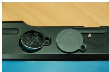
2. 將新電池從上方卡榫放入後壓緊，再蓋回電池蓋並鎖上螺絲即完成更換。
