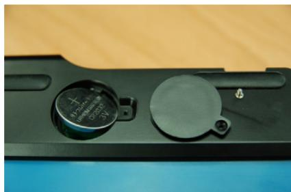
2. Mettez la nouvelle pile, puis replacez le couvercle de la batterie et serrer la vis pour finir.
