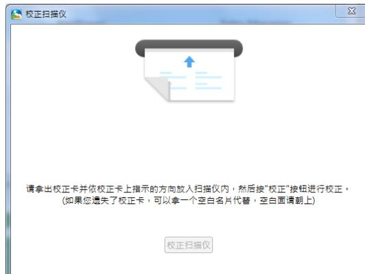
提醒: 放置校正卡时, 请将空白面朝上; 若校正卡遗失, 请以空白名片或纸张代替进行校正。
