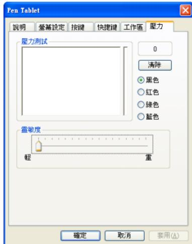
**5. 壓力測試**：有四種不同的顏色供選擇讓您在此測試筆的壓力及靈敏度。測試區中的線條粗細代表壓力值的變化。
